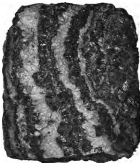
Fig. 79. Lagenförmige Verwachsung von Zinkblende und Quarz. Unterer Burgstädter Zug.
